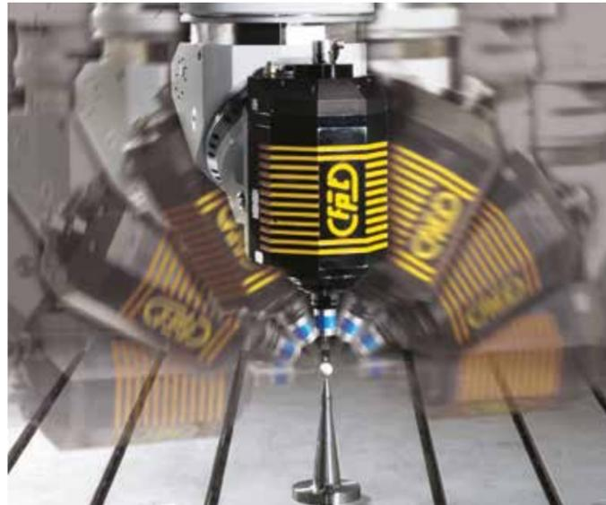
**FPT TECHNOLOGIE ZUR AUTOMATISCHEN UND SELBSTSTÄNDIGEN KORREKTUR DER KOPFGEOMETRIE SEITENS DES BEDIENERS**
